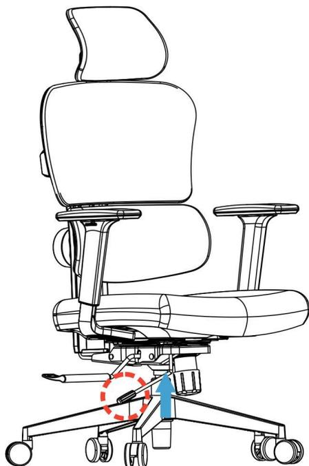
De pie al lado derecho de la silla, con una mano levanta el mecanismo de ajuste de la profundidad del asiento, y con la otra mano colócala en el extremo del cojín del asiento. Agarra el cojín del asiento para moverlo hacia adelante y hacia atrás y ajustar la profundidad del asiento. Es imprescindible mantener la base de la silla quieta con uno de tus pies cuando muevas el asiento hacia adelante.
