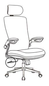
Para elevar el asiento, levanta la palanca mientras te levantas ligeramente de la silla.
